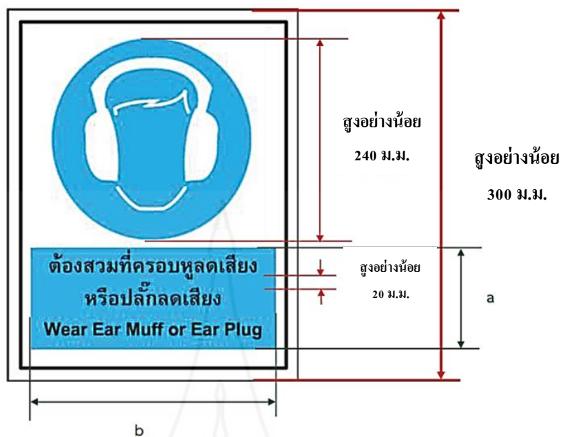
ภาพที่ 34 รูปแบบและขนาดเครื่องหมายเตือนให้ใช้อุปกรณ์คุ้มครองความปลอดภัยส่วนบุคคล ที่มา : กองความปลอดภัยแรงงาน กรมสวัสดิการและคุ้มครองแรงงาน กระทรวงแรงงาน
