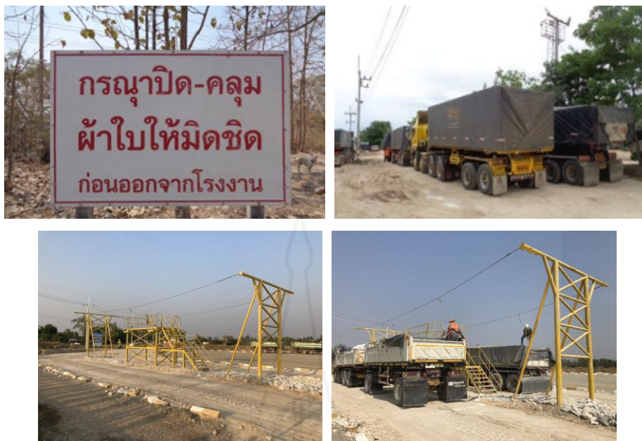
ภาพที่ 26 จุดคลุมผ้าใบและรถบรรทุกปิดคลุมผ้าใบ
