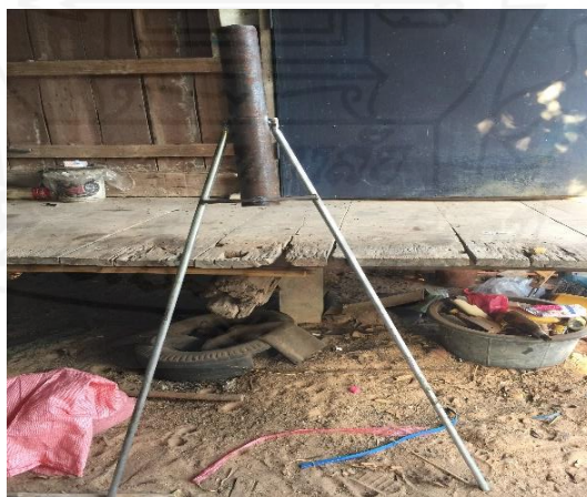
ภาพที่ 4.5 เหล็กตอกเสา เพื่อก้ำยันค้ำผัก
