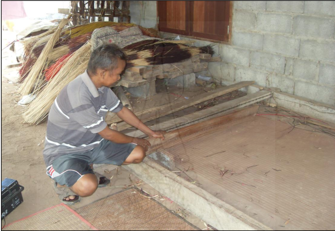
ภาพที่ 4.13 การร้อยเชือกไถล่อนเข้าฟืมบนโครงกึ่งทอ
