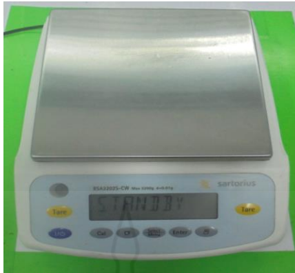
ภาพที่ 3.10 เครื่องชั่งทศนิยม 2 ตำแหน่ง Sartorius รุ่น BSA3202S-CW
