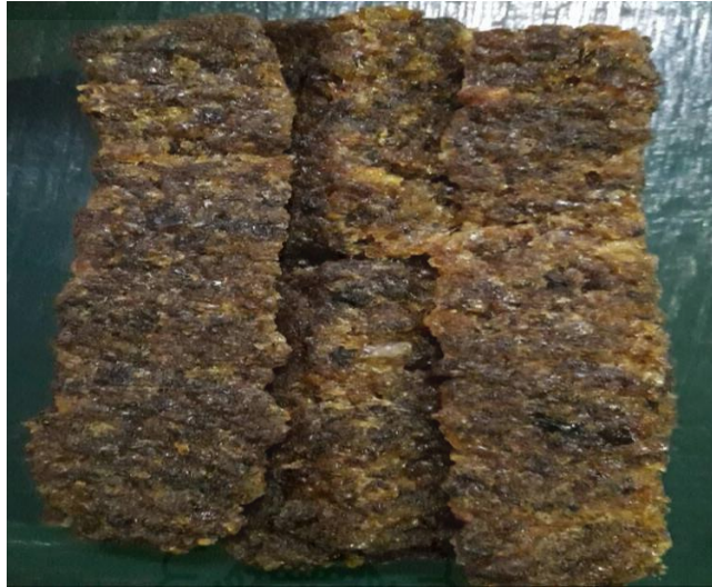
ภาพที่ 3.26 ลักษณะการประกบตัวอย่างยางก่อนบรรจุถุงตามเกณฑ์ของบริษัท
