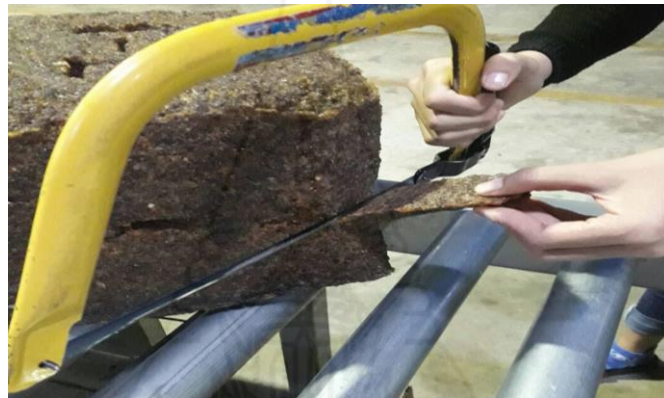
ภาพที่ 3.24 การตัดตัวอย่างยางแท่งยางแท่ง MNRตามเกณฑ์ของบริษัท
