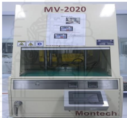
ภาพที่ 3.6 เครื่องทดสอบความหนืด Montech รุ่น MV-2020
