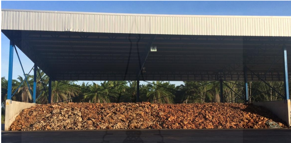
ภาพที่ 3.12 การเก็บบ่มแบบที่อากาศถ่ายเทได้สะดวก
