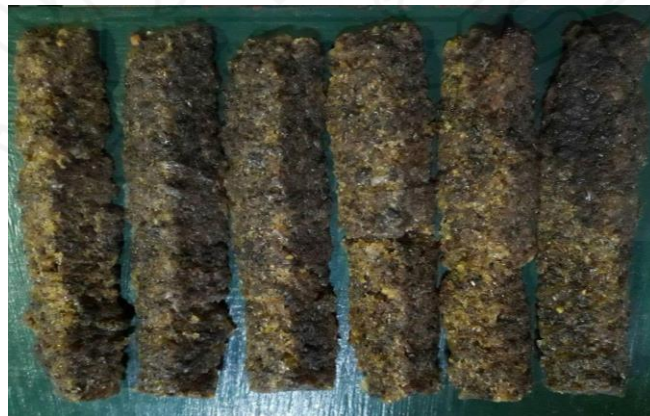
ภาพที่ 3.25 ลักษณะตัวอย่างยางที่ทำการตัดมุมตามเกณฑ์ของบริษัท
