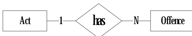
ภาพที่ 3.35 แสดงแผนภาพความสัมพันธ์ของ เอนทิตี Act กับเอนทิตี Offence
