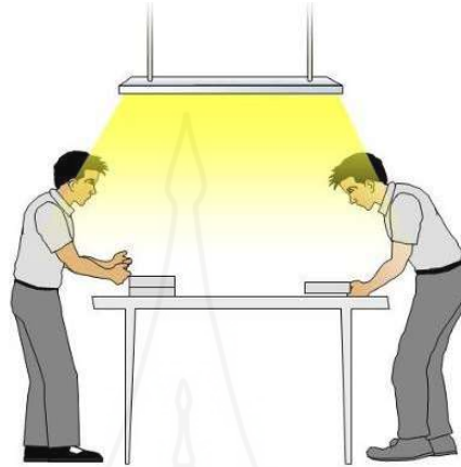
ภาพที่ 48 การติดตั้งแหล่งกำเนิดแสงสว่างเฉพาะจุด
