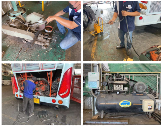
ภาพที่ 23 ตัวอย่างปัจจัยเสี่ยงด้านสิ่งแวดล้อมด้านกายภาพเกี่ยวกับเสียงดังในการทำงานซ่อมบำรุง
