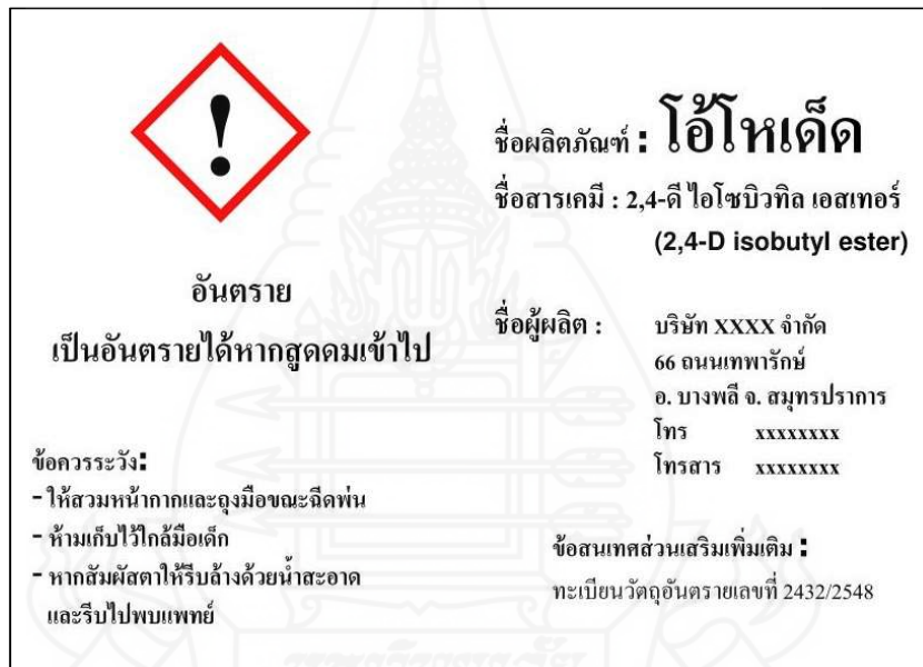
ภาพที่ 28 ตัวอย่างฉลากที่ติดอยู่บนภาชนะสารเคมีอันตราย
