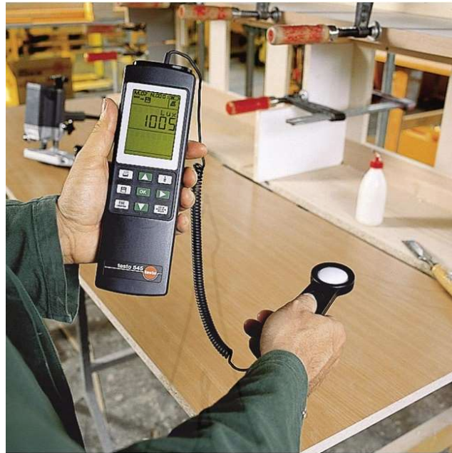
ภาพที่ 8 เครื่องมือตรวจวัดแสงสว่าง ที่มา : https://www.synes.co.th/blog/lux-meter/
