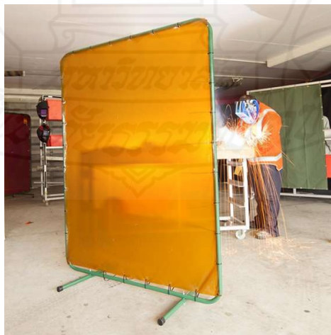
ภาพที่ 42 ชุดฉากกันแสงและสะเก็ดไฟเชื่อม
