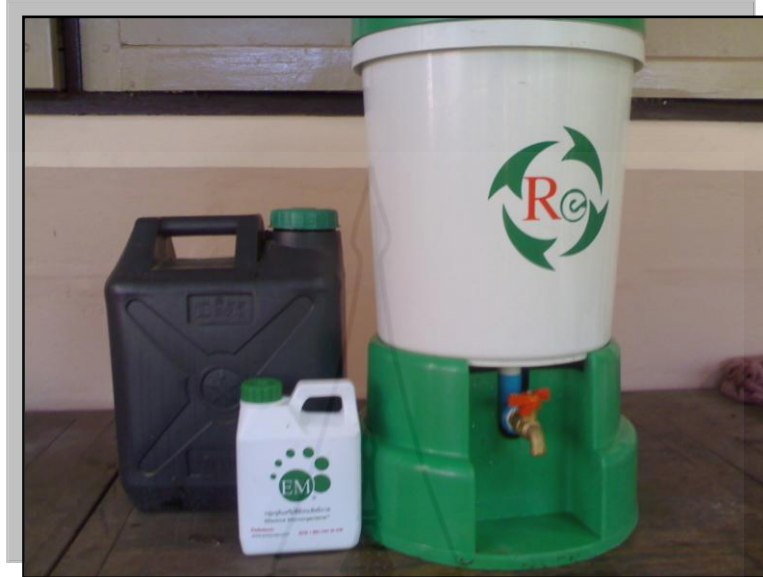
ภาชนะที่ ข-1 ถังพลาสติก ขนาด 50 ลิตร ใช้หมัก
