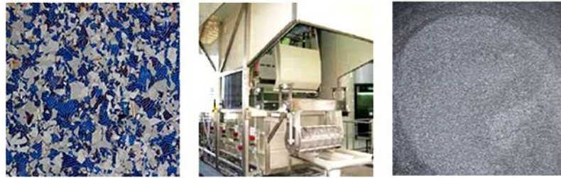
ภาพที่ 24 ผลึกโซลาร์เซลล์ที่ผ่านการกัดชั้นป้องกันการสะท้อนแสงแล้วถูกนำมาหลอมใหม่อีกครั้ง ที่มา : กรมพัฒนาพลังงานทดแทนและอนุรักษ์พลังงาน กระทรวงพลังงาน (2560)
