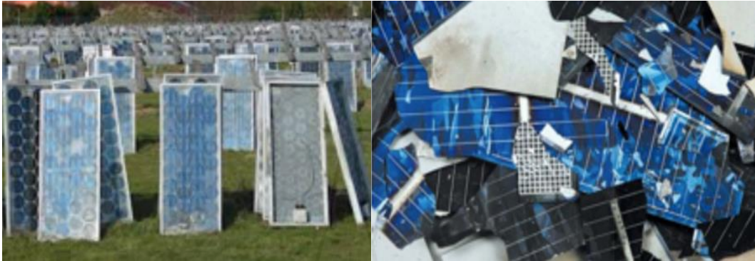
ภาพที่ 19 ลักษณะของการหมดอายุหรือเสื่อมสภาพของแผงโซลาร์เซลล์ ที่มา : กรมพัฒนาพลังงานทดแทนและอนุรักษ์พลังงาน กระทรวงพลังงาน (2560)
