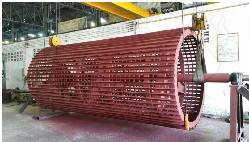
ภาพที่ ค-5 FABRICATION OF NEW THRESHING DRUM
