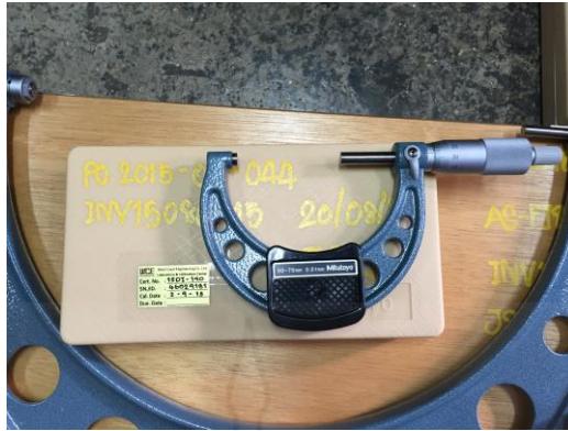
ภาพที่ 4.20 เครื่องมือวัดที่ทำการสอบเทียบเครื่องมือวัด (Calibration)
