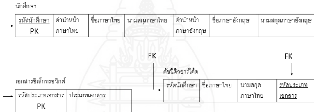
ภาพที่ 3.16 โครงสร้างตารางฐานข้อมูลเชิงสัมพันธ์ในระบบจัดการเอกสารอิเล็กทรอนิกส์โดยใช้คิวอาร์โค้ด
