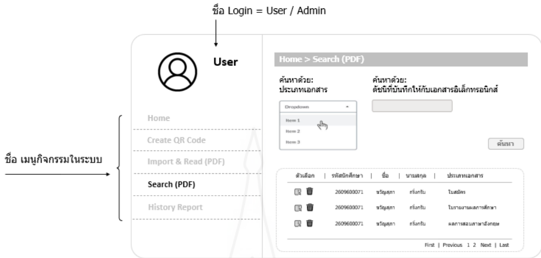
ภาพที่ 3.8 ส่วนติดต่อกับผู้ใช้งาน การสืบค้นเอกสารอิเล็กทรอนิกส์ ระบบจัดการเอกสารอิเล็กทรอนิกส์โดยใช้คิวอาร์โค้ด
