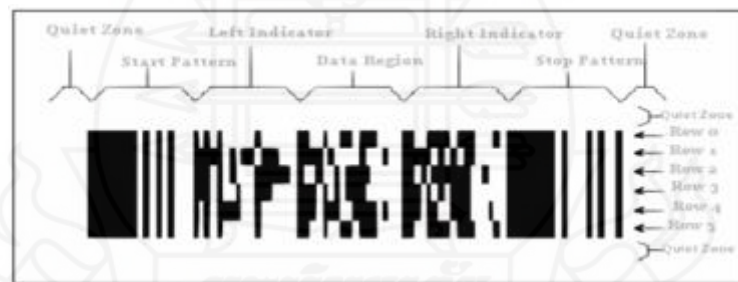
ภาพที่ 2.7 บาร์โค้ดแบบสแต็ก (Stacked Barcode) ที่มา: อเสข ชันธวิชัย, 2558.
