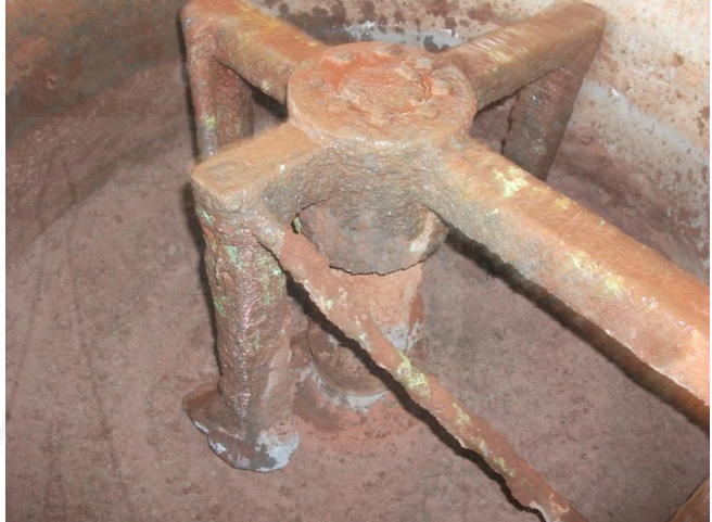
ภาพที่ 3.6 ขั้นตอนการผสม ก่อนนำมาขึ้นรูปอัดบล็อกประสาน โดยใช้เครื่องมือผสม
