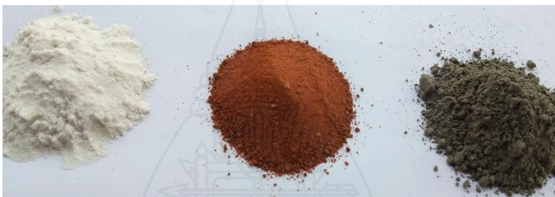
ภาพที่ 3.1 วัสดุที่ใช้ในการทดลอง กากตะกอนจากการทำน้ำเกลือให้บริสุทธิ์ (ซ้าย) ดินจากนิคมพัฒนา (กลาง) และปูนซีเมนต์ปอร์ตแลนด์ประเภทที่ 1 ตราช้าง (ขวา)
