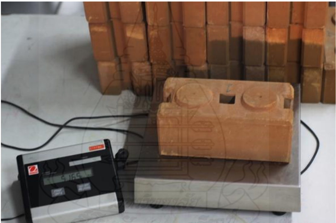
ภาพที่ 3.10 การชั่งน้ำหนักบล็อกประสานเพื่อหาร้อยละการดูดกลืนน้ำ
