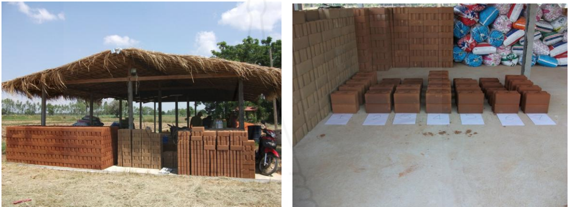
ภาพที่ 3.8 การบ่มบล็อกประสาน โดยบ่มในโรงผลิตป้องกันการสัมผัสแสงแดดและลม โดยตรง
