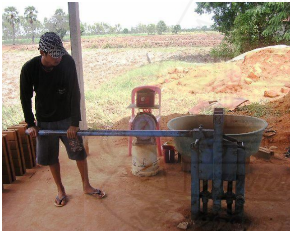
ภาพที่ 3.7 การขึ้นรูปอัดบล็อกประสาน โดยใช้เครื่องอัดแบบใช้แรงคน
