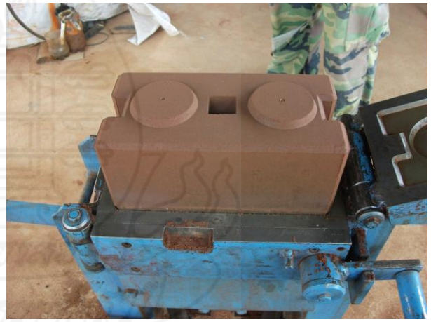
ภาพที่ 3.7 การขึ้นรูปอัดบล็อกประสาน โดยใช้เครื่องอัดแบบใช้แรงคน
