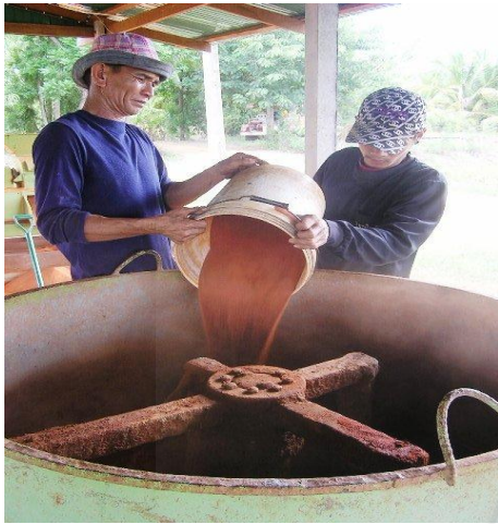
ภาพที่ 3.6 ขั้นตอนการผสม ก่อนนำมาขึ้นรูปอัดบล็อกประสาน โดยใช้เครื่องมือผสม
