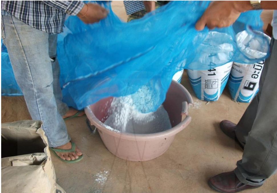
ภาพที่ 3.5 การร่อนกากตะกอนจากกระบวนการทำน้ำเกลือให้บริสุทธิ์เพื่อแยกเอาเศษวัสดุอื่นที่ปะปนออกก่อนทำการผสม
