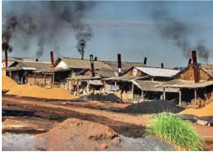
ภาพที่ 2.24 เขม่าควันจากการต้มเกลือพร้อมกันหลาย ๆ เตาต้ม
