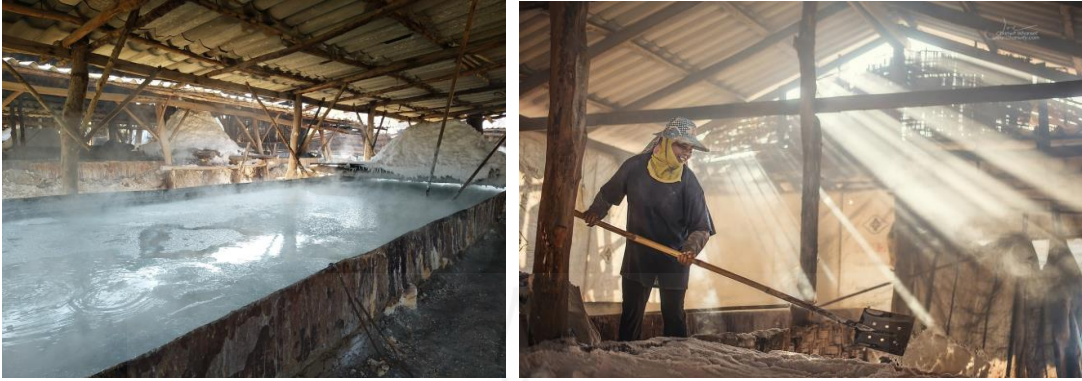
ภาพที่ 2.18 การตม้มน้ำเกลือให้ระเหยได้ผลึกเกลือ
