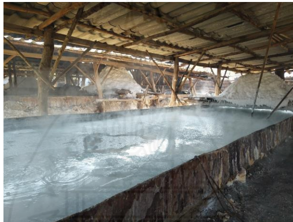
ภาพที่ 2.9 ลักษณะเตาต้มเกลือแบบดั้งเดิม
