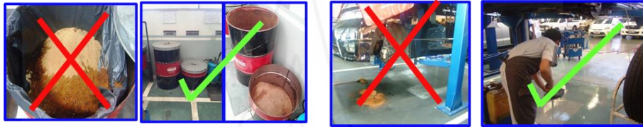
ภาพที่ 5.8 การใช้ขี้เลื่อยในการจับสารเคมี
