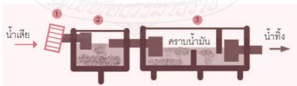
ภาพที่ 2.3 การกำจัดน้ำมันและไขมัน โดยใช้บ่อดักไขมัน
