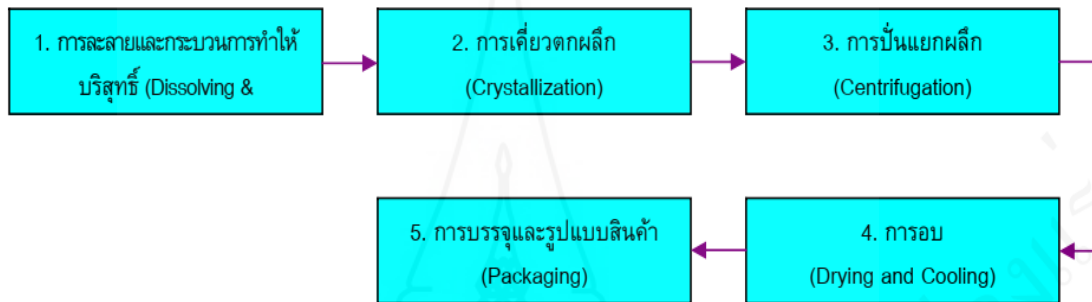
ภาพที่ 2.9 กระบวนการผลิตน้ำตาลทรายขาวและน้ำตาลรีไฟน์
