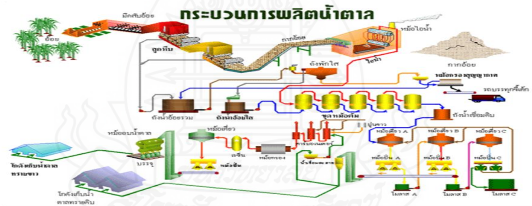
ภาพที่ 2.6 กระบวนการผลิตน้ำตาลทรายดิบ
