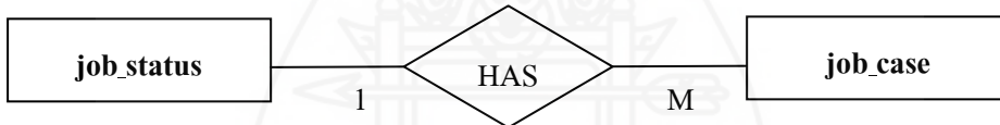
ภาพที่ 4.12 ความสัมพันธ์ระหว่างเอนทิตี job_status กับ เอนทิตี job_case
