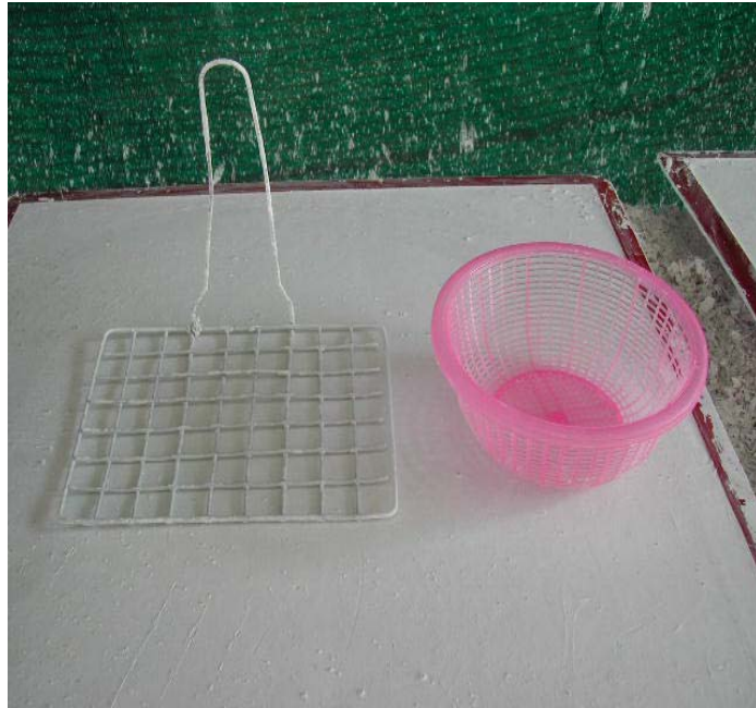
ภาพที่ ก.7 อุปกรณ์ไล่ฟองอากาศของอุตสาหกรรมครัวเรือน
