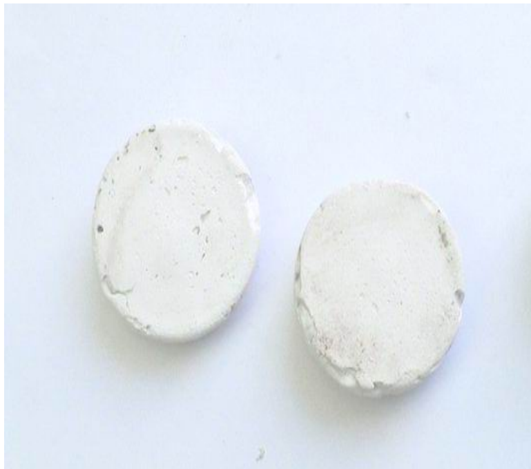
ภาพที่ ข.3 ตัวอย่างขั้นตอนทดสอบอัตราส่วนปูนยิปซัม 1 ส่วน ต่อโคลนปูน 3 ส่วน
