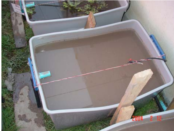
ภาพที่ 3.7 บ่อควบคุม ควบคุมระดับน้ำให้ลึก 20 เซนติเมตร
