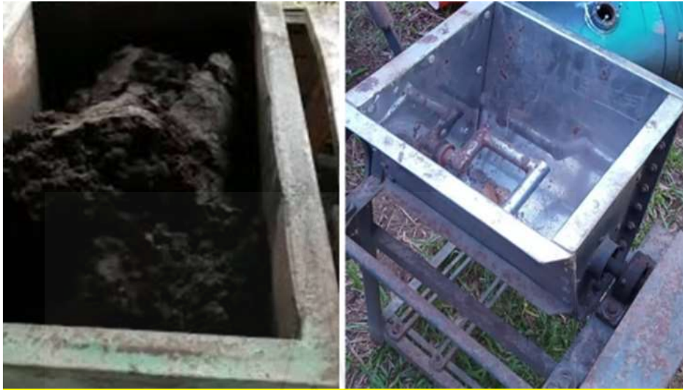
ภาพที่ 3.6 เครื่องผสมก้อนปลุกพืชสำเร็จรูป
