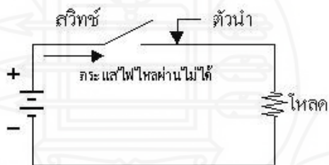
รูปที่ 1.8 แสดงวงจรไฟฟ้าแบบวงจรเปิด
