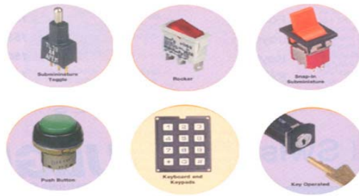
รูปที่ 1.5 แสดงอุปกรณ์ที่ใช้เป็นสวิตช์ในวงจร
