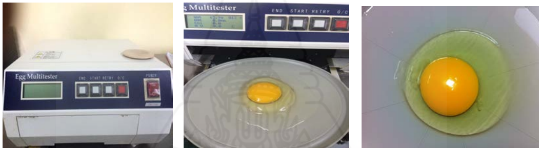
ภาพที่ 2 การวัดความสูงไข่ขาว และสีไข่แดง โดยใช้เครื่อง Egg Multitester
