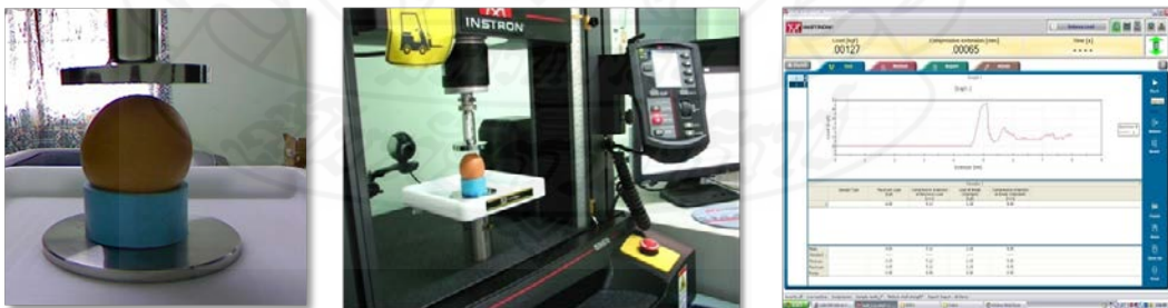
ภาพที่ 3 การวัดความแข็งเปลือกไข่ โดยใช้เครื่อง Instron Model 5695
