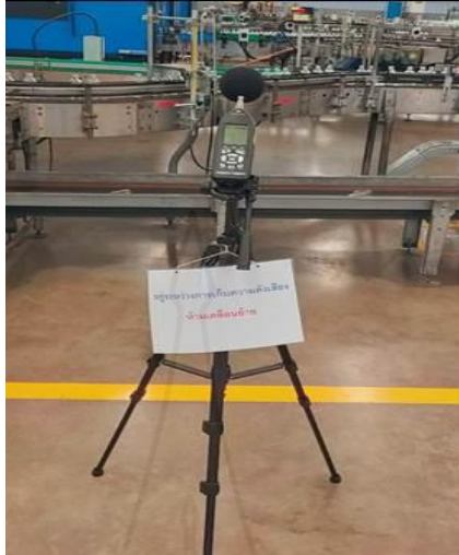
ภาพที่ 3.7 แสดงการติดตั้งเครื่องวัดเสียง
