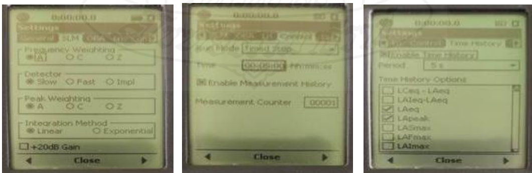
ภาพที่ 3.8 แสดงการตั้ง Parameter เครื่องวัดเสียง
