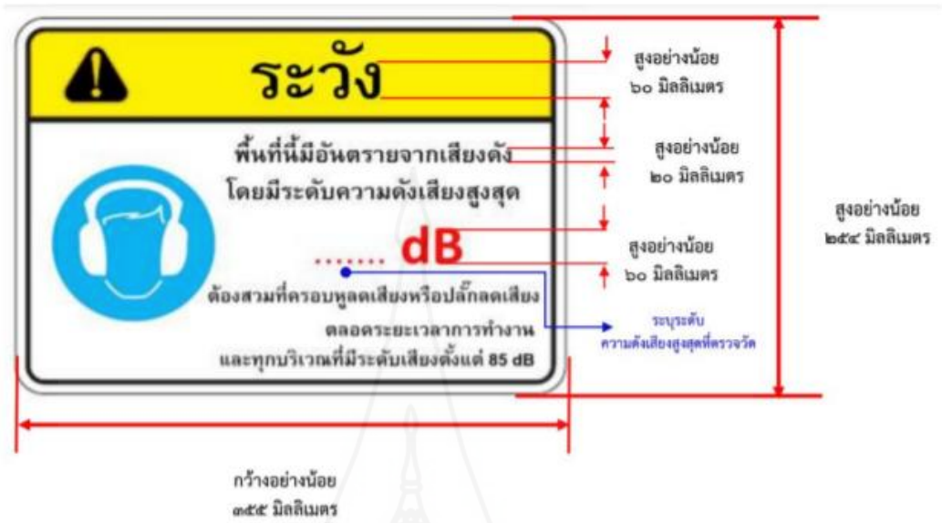
ภาพที่ 2.18 รูปแบบและขนาดของป้ายบอกระดับเสียงและเตือนให้ระวังอันตรายจากเสียง ที่มา : ประกาศกรมสวัสดิการและคุ้มครองแรงงาน. (2561)
