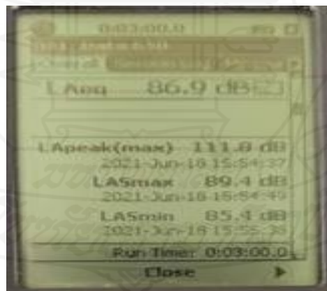
ภาพที่ 3.10 แสดงผลการบันทึกค่าระดับความดังเสียงเฉลี่ยเมื่อครบ 5 นาที
