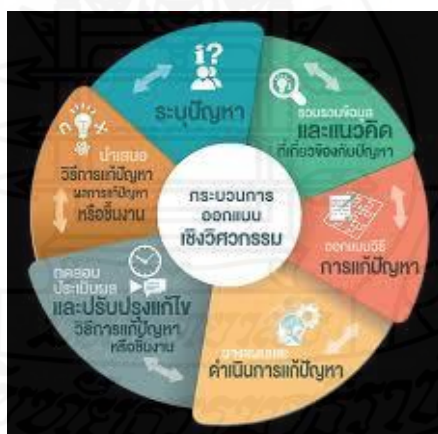
ภาพที่ 2.3 วงจรกระบวนการออกแบบเชิงวิศวกรรม 6 ขั้นตอน
