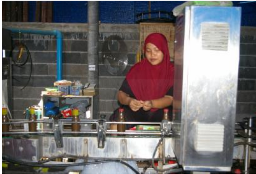
ภาพที่ 417 ภาพคนงานกำลังปิดฝาและติดสติ๊กเกอร์เครื่องหมายการค้า โดยใช้เครื่องจักร ถ่ายทำ ณ. โรงผลิตน้ำบุงดู ของ คุณอิบรอเฮม แม
