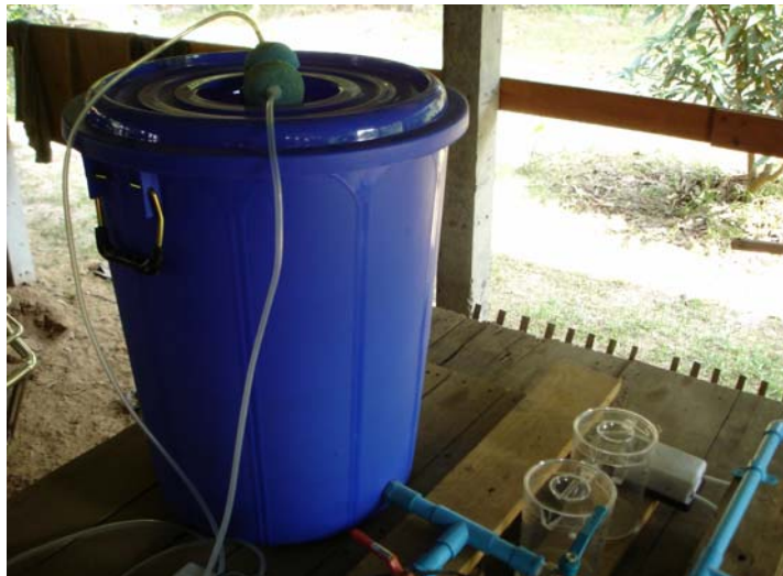
ภาพที่ 3.2 บ่อเก็บกักน้ำเสีย
