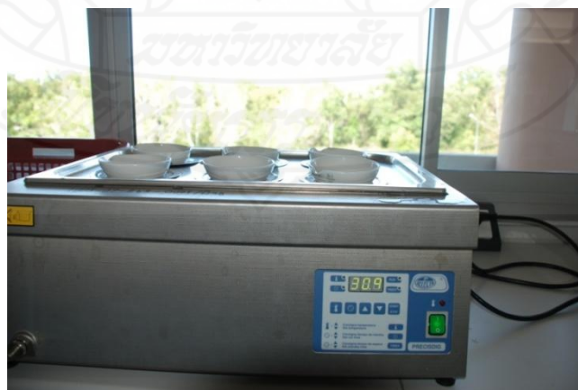
ภาพที่ ข-9 การทดลองหาปริมาณของแข็งละลายน้ำทั้งหมด
