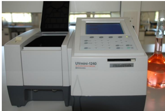
ภาพที่ ข-7 การวัดค่าการดูดกลืนแสงด้วย เครื่อง ยูวี-วิสิเบิลสเปกโทรโฟโตมิเตอร์
