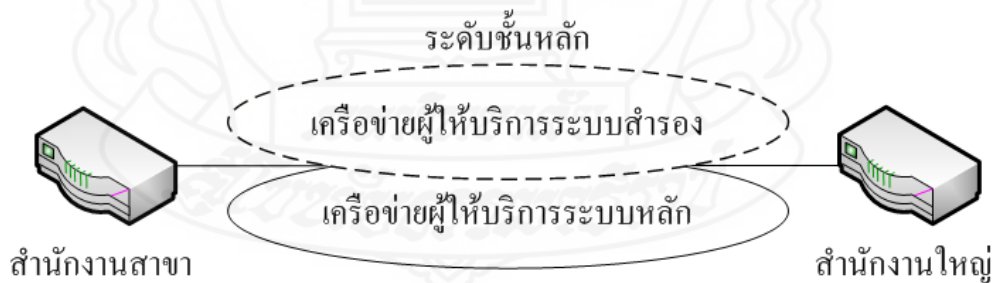
ภาพที่ 3.3 การออกแบบการเชื่อมต่อเครือข่ายระหว่างสำนักงานใหญ่กับสำนักงานสาขา
