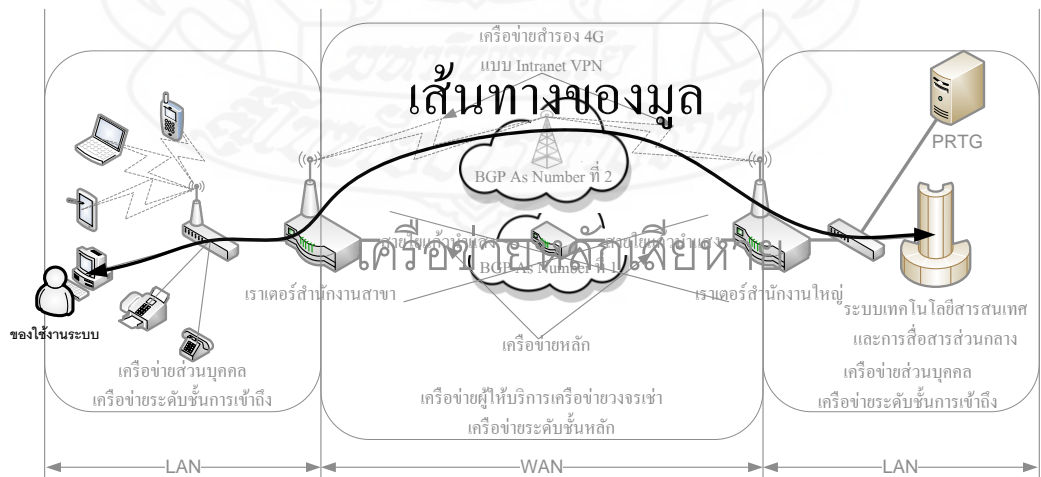
ภาพที่ 4.8 เส้นทางข้อมูลจะถูกส่งผ่านเครื่องข่ายหลักด้วยการเลือก BGP As number 2
