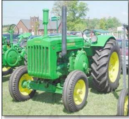
ภาพที่ 2.10 รถแทรกเตอร์แบบมาตรฐาน (Standard tread tractor)
