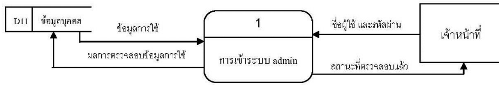
ภาพที่ 3.2 แผนภาพการไหลของข้อมูลระดับที่ 1 กระบวนการ เข้าสู่ระบบ
