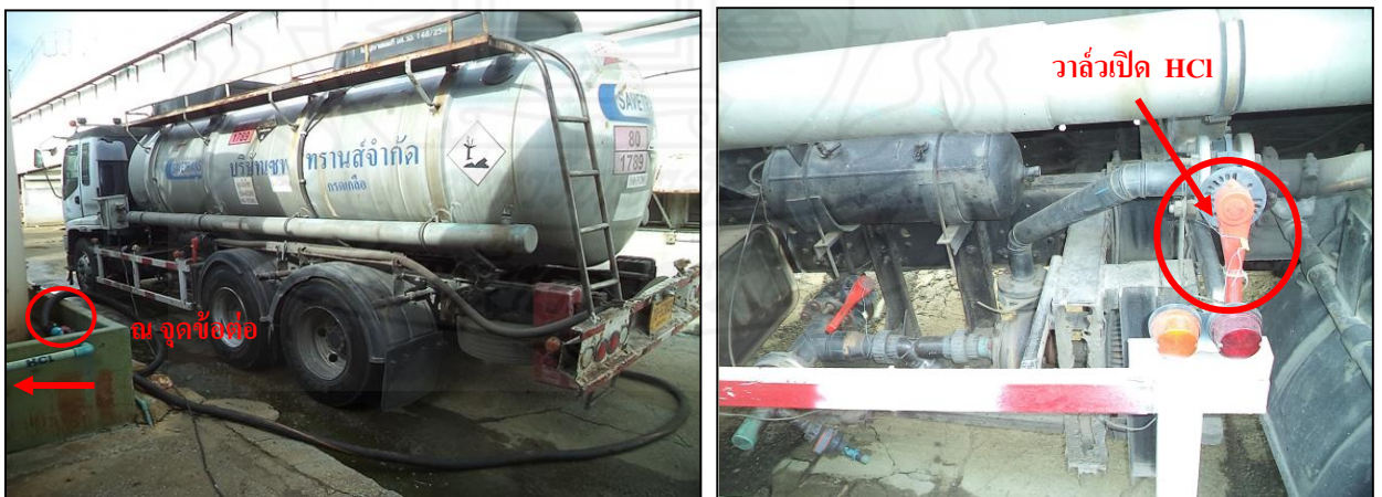
ภาพที่ 4.1 การเปิดวาล์วรถบรรทุกขนถ่าย HCl ลงแท็งก์พลาสติก PE
