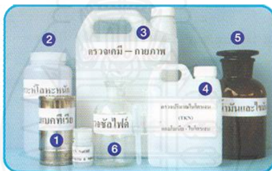
ภาพที่ 4.8 ชุดตรวจคุณภาพน้ำเสีย/น้ำทิ้ง
