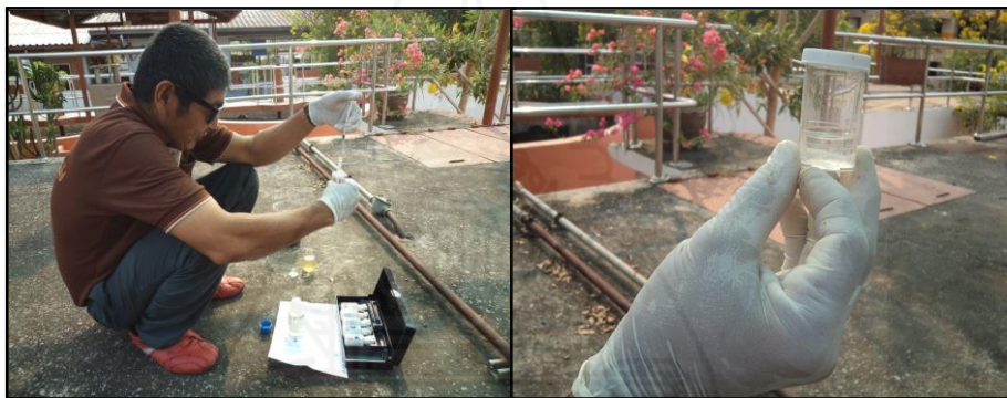
ภาพที่ 2.42 การตรวจสอบวัดค่าปริมาณออกซิเจนที่ละลายน้ำ (Dissolved Oxygen : DO)
