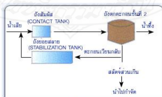
ภาพที่ 2.9 ระบบแอกทิเวเต็ดสลัดจ์แบบปรับเสถียรสัมผัส
