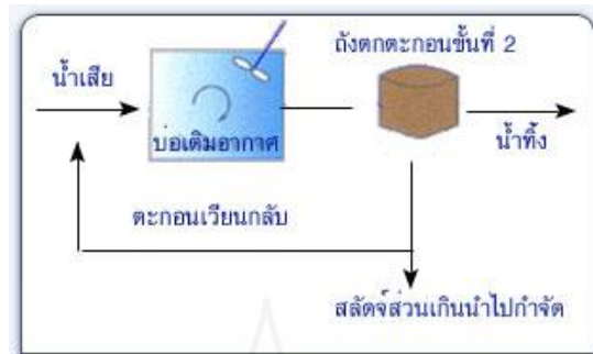
ภาพที่ 2.8 ระบบแอกทิเวเต็ดสลัดจ์แบบกวนสมบูรณ์
