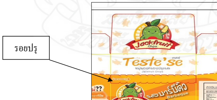
ภาพที่ 4.14 การเพิ่มรอยปรุบนกล่องบรรจุภัณฑ์
