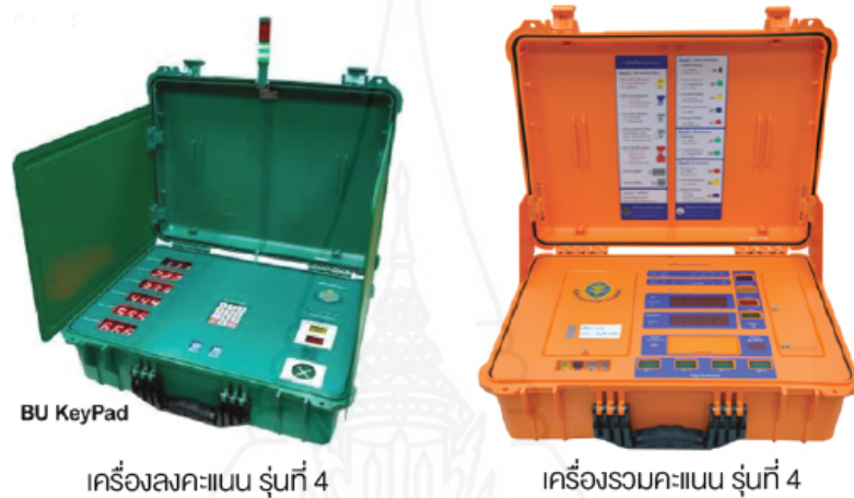
ภาพที่ 2.5 เครื่องลงคะแนนเลือกตั้งอิเล็กทรอนิกส์ต้นแบบรุ่นที่ 4 (เครื่องผสมหมายเลข)
