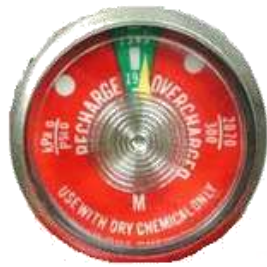
เข็มอยู่ในช่องสีเขียว ถึงดับเพลิงพร้อมใช้งาน
