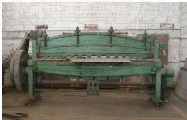
ภาพที่ 2.21 เครื่องตัดโลหะแผ่นแบบใช้เท้าเหยียบ
