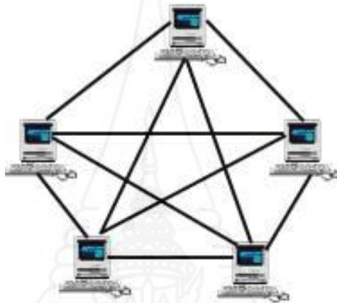
ภาพที่ 2.4 แสดงโครงสร้างเครือข่ายคอมพิวเตอร์แบบเมช
