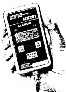
ภาพที่ 2.6 เครื่องมือในการตรวจวัดปริมาณออกซิเจน
