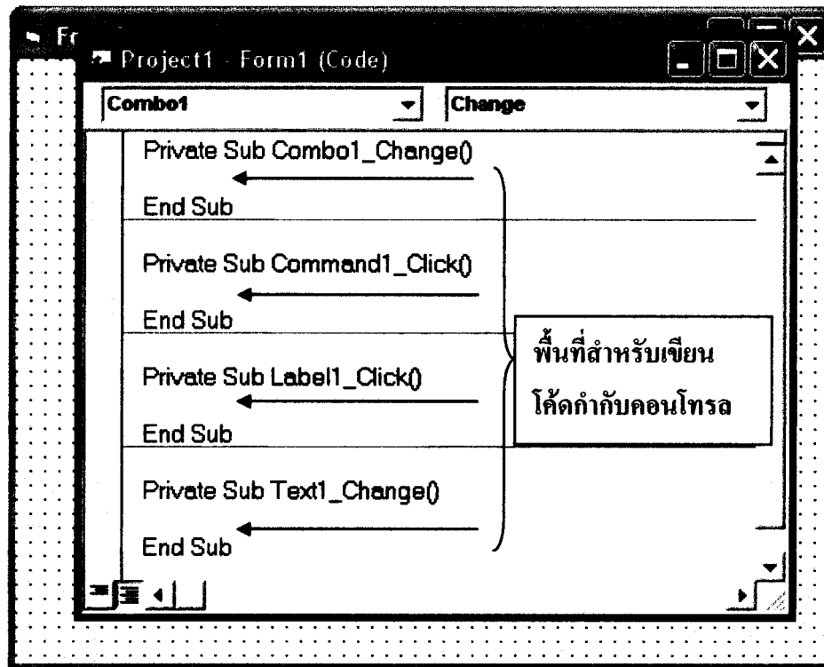
ภาพที่ 2.3 หน้าต่างสำหรับการเขียนโค้ดกำกับคอนโทรล
