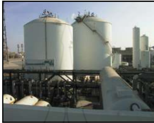
ภาพที่ 3.19 ถังเก็บก๊าซเหลวขนาดใหญ่ (Storage Tank)
