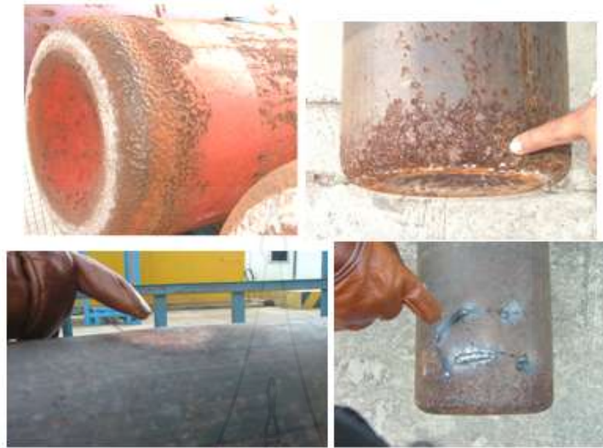
ภาพที่ 6.12 ตัวอย่างความเสียหายบนท่อบรรจุก๊าซ
