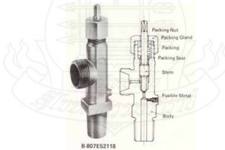
ภาพที่ 6.9 จุกหลอมละลาย (Fusible plug)
