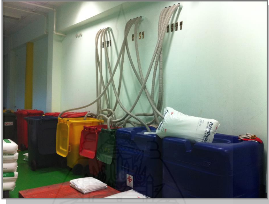
ภาพที่ 2.13 ท่อดูดเม็ดพลาสติกเข้าเครื่องผลิตฟิล์มพลาสติก
