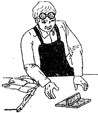
รูปที่ 5 แสดง การระวังชิ้นงานร้อนต้องใช้คีมจับ
