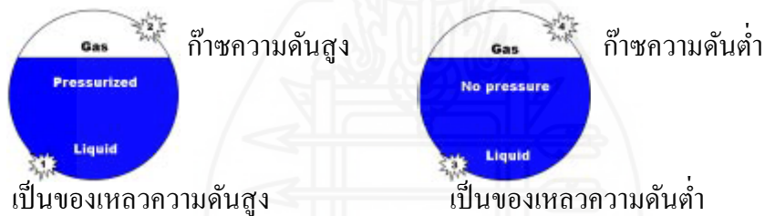
ภาพที่ 4.18 รูปแบบการรั่วไหลของแอมโมเนีย
