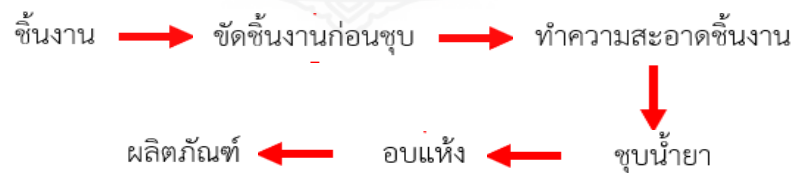
ภาพที่ 2.3 ขั้นตอนการชุบโลหะด้วยไฟฟ้าอย่างง่าย
