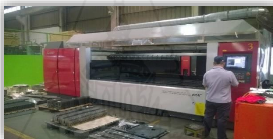
ภาพที่ 3.7 การตัดชิ้นงานด้วยเครื่องเลเซอร์
