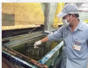
ภาพที่ 3.13 นำชิ้นงานมาแช่ขังบ่อกรดไฮโดรคลอริก
