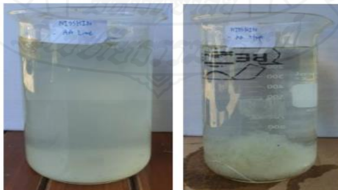
ภาพที่ 4.10 ลักษณะน้ำเสียก่อนและหลังการบำบัดของบ่อกรด
