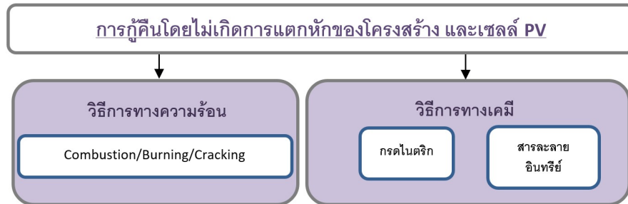
ภาพที่ 4.23 แนวทางการกำจัดสารหล่อหลอมออกจากโครงสร้างลามิเนตของเซลล์แสงอาทิตย์แบบผลึก ในระยะแรก [38]
