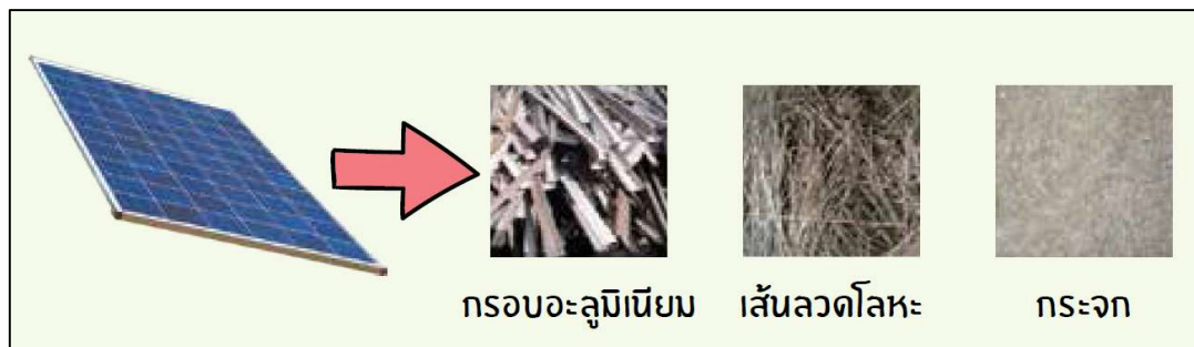
ภาพที่ 4.17 การแยกส่วนประกอบต่างๆของแผงเซลล์แสงอาทิตย์ที่สามารถนำกลับมาใช้ใหม่
