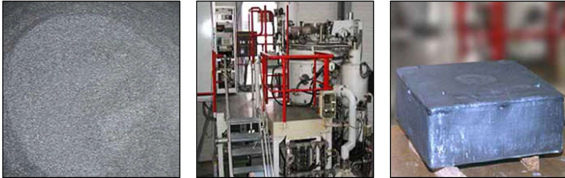
ภาพที่ 4.22 ตัวอย่างผลึกเซลล์แสงอาทิตย์ที่ผ่านการหลอมใหม่อีกครั้ง
