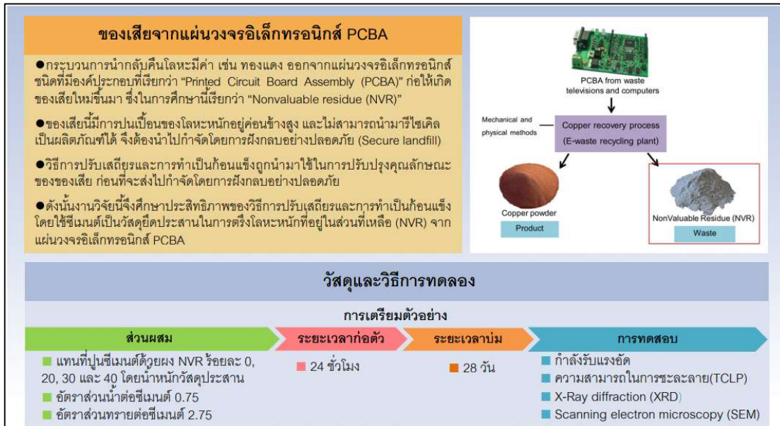
ภาพที่ 4.33 การปรับเสถียรและการทำเป็นก้อนแข็งซากแผงวงจรอิเล็กทรอนิกส์ (แผงวงจรพิมพ์)
