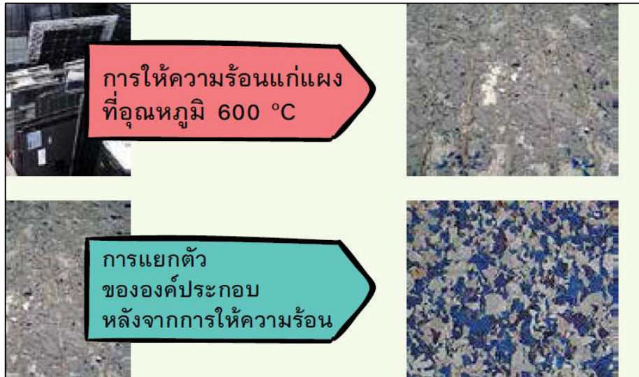
ภาพที่ 4.18 ตัวอย่างแผงเซลล์แสงอาทิตย์ที่ถูกนำไปเผาด้วยความร้อน 600 องศาเซลเซียส
