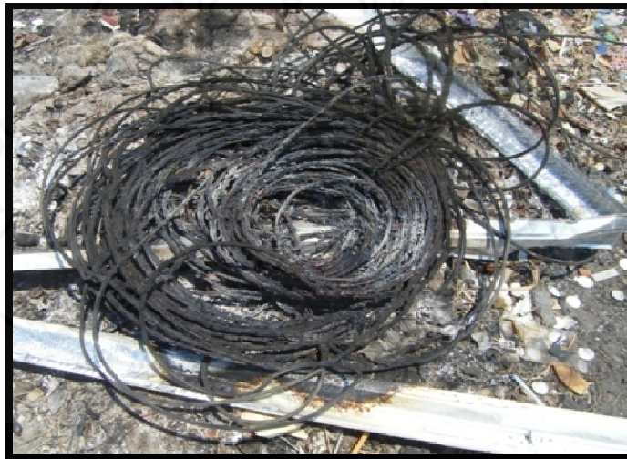
ภาพที่ 4.9 แสดงการแยกชิ้นส่วนทองแดงจากสายไฟโดยการเผา
