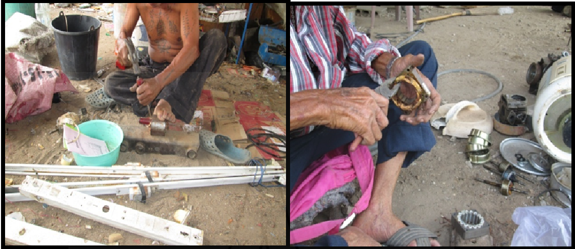
ภาพที่ 4.10 แสดงการแกะแยกทองแดงจากชิ้นส่วนซากเครื่องใช้ไฟฟ้าโดยการแกะ ทาบ ึงด
