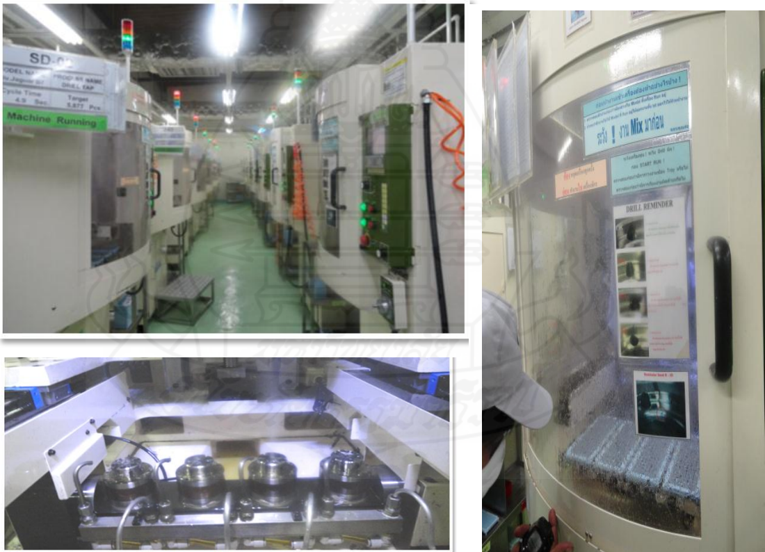
ภาพที่ 5.1 ภาพแสดงการพ่นชิ้นงานออกจากอุปกรณ์จับยึดโดยใช้อากาศ ซึ่งส่งผลกระทบในส่วนของสภาพแวดล้อมในการทำงานและสุขภาพของพนักงาน
