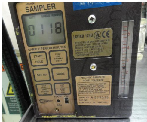
ภาพแสดงการตรวจวัดปริมาณละอองน้ำมัน
