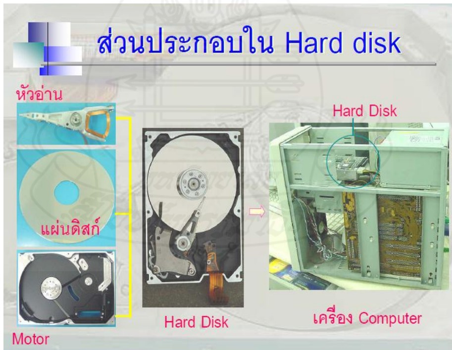
ภาพที่ 2.5 แสดงส่วนประกอบของอุปกรณ์เก็บข้อมูลในเครื่องคอมพิวเตอร์
