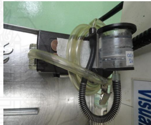
ภาพแสดงการตรวจวัดปริมาณละอองน้ำมัน
