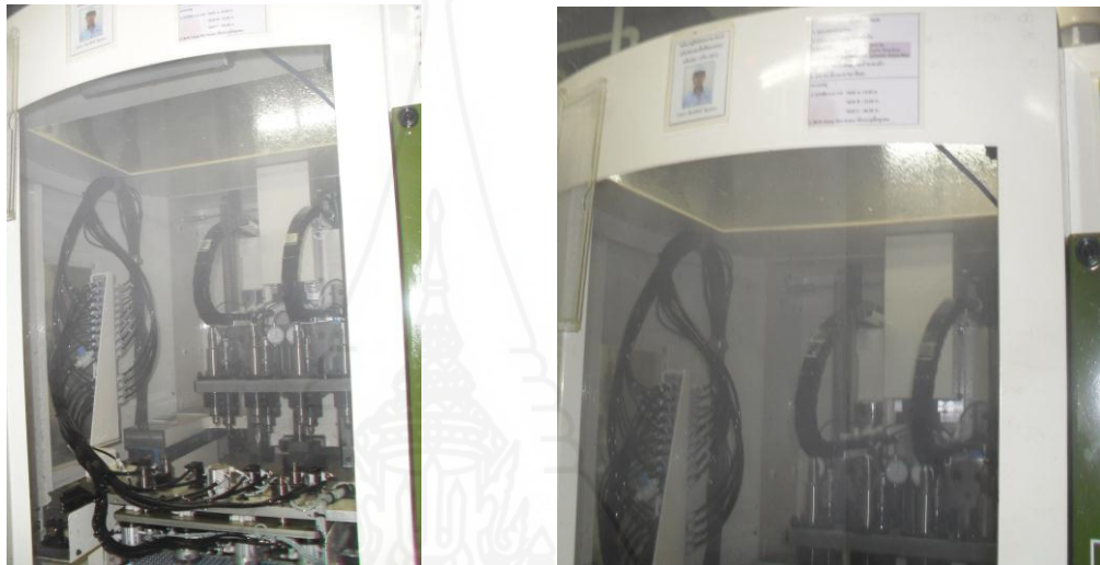
ภาพที่ 3.10 ลักษณะของละอองน้ำมันในเครื่องจักรก่อนการปรับปรุง
