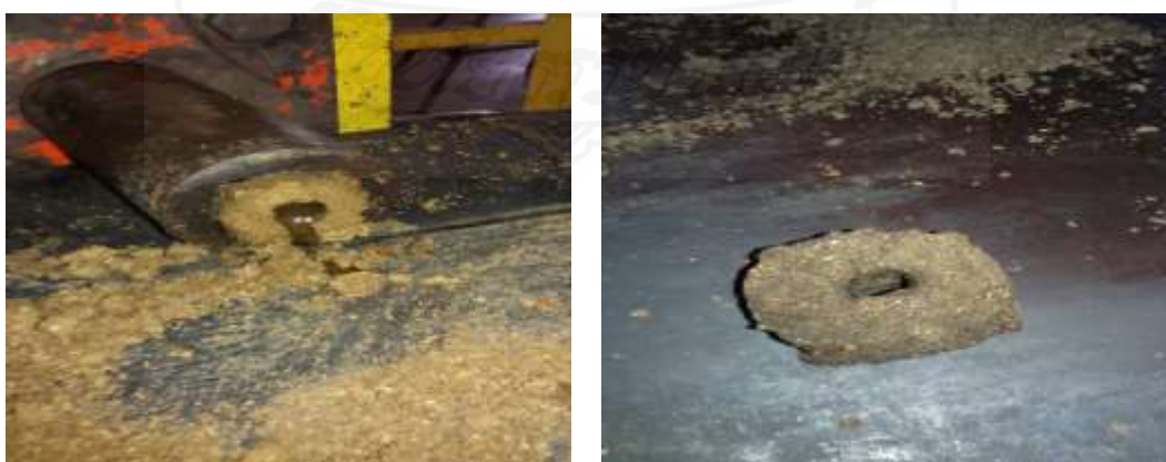
ภาพที่ 4.5 การอัดแท่งเชื้อเพลิงที่อุณหภูมิกระบอกอัดแท่งสูงกว่าปกติ
