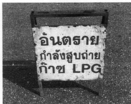
ภาพที่ 6.14 ป้ายเตือนอันตราย กำลังถ่ายเทก๊าซ
