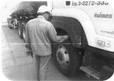
ภาพที่ 6.2 สภาพยางรถบรรทุก ดอกยาง ความดันลมยาง
