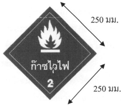
ภาพที่ 5.2 สัญลักษณ์ ก๊าซไวไฟ ที่ติดบนถังรถขนส่งก๊าซปิโตรเลียมเหลว
