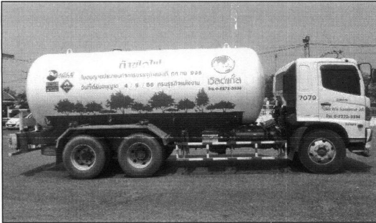
ภาพที่ 4.3 ถังขนส่งแก๊สปิโตรเลียมเหลวปริมาตร 8 ตัน
