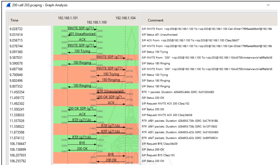
ภาพที่ 4.31 แสดงกราฟกระบวนการทำงานของการโทรจากหมายเลขภายใน 200 ไปยังหมายเลข 203
