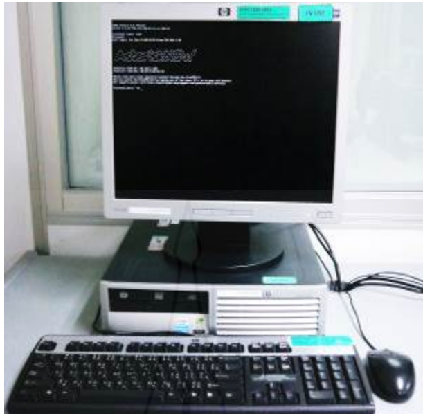
ภาพที่ 3.6 แสดงเครื่องแม่ข่ายที่ทำการติดตั้ง โปรแกรม Asterisk เพื่อทำหน้าที่เป็น IP-PBX
