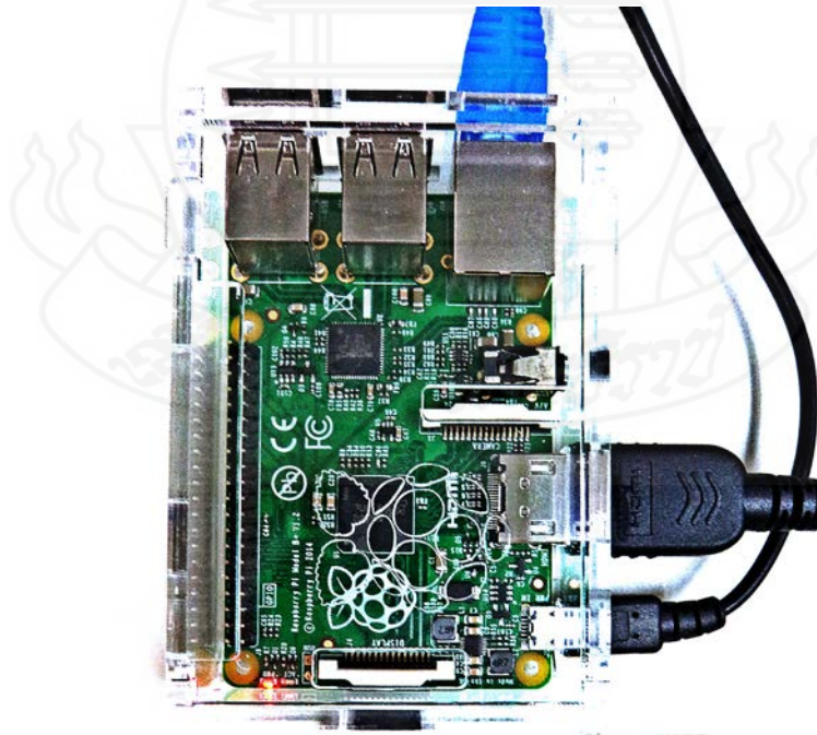
ภาพที่ 3.13 แสดงการต่อเชื่อมสาย HDMI, สาย LAN และ Mini USB Power
