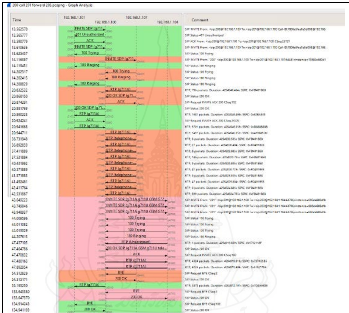
ภาพที่ 4.42 แสดงกราฟกระบวนการทำงานการสานตันทระหว่างเบอร์ 200 และ 201 จากนั้นหมายเลข 201 โอนสายไปยังหมายเลข 203
