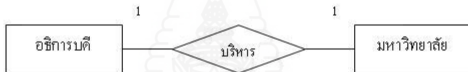
ภาพที่ 2.6 แสดงความสัมพันธ์แบบหนึ่งต่อหนึ่ง
