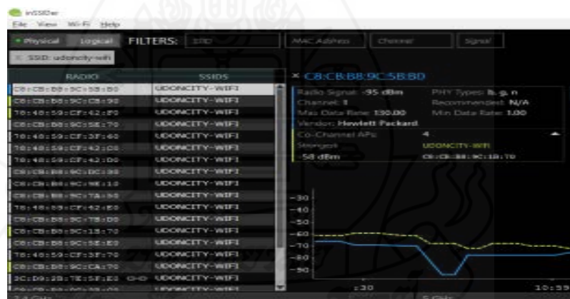
ภาพที่ 44 การตรวจสอบการรบกวนในช่องสัญญาณเดียวกันและการทับซ้อนของสัญญาณเครือข่ายฯ ชั้น 3 อาคารเฉลิมพระเกียรติฯ
