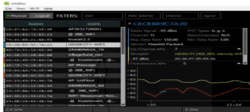
ภาพที่ 49 การตรวจสอบการรบกวนในช่องสัญญาณเดียวกันและการทับซ้อนของสัญญาณเครือข่าย ชั้น G อาคารอัจฉริยะ
