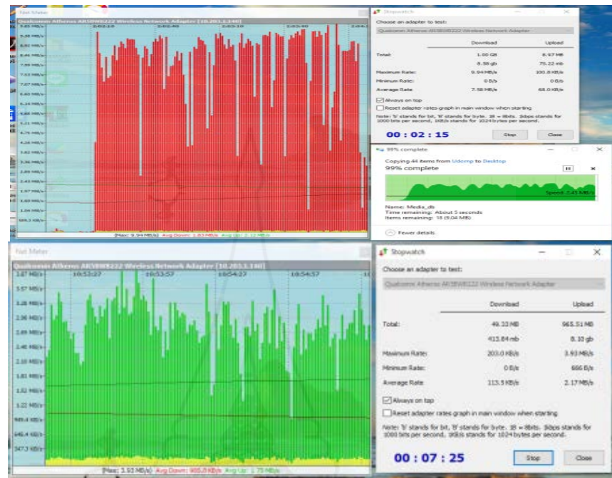
ภาพที่ 75 การอัปโหลดและดาวน์โหลดข้อมูลผ่านระบบเครือข่ายแลนไร้สาย ชั้น 2 อาคารอัจฉริยะ
