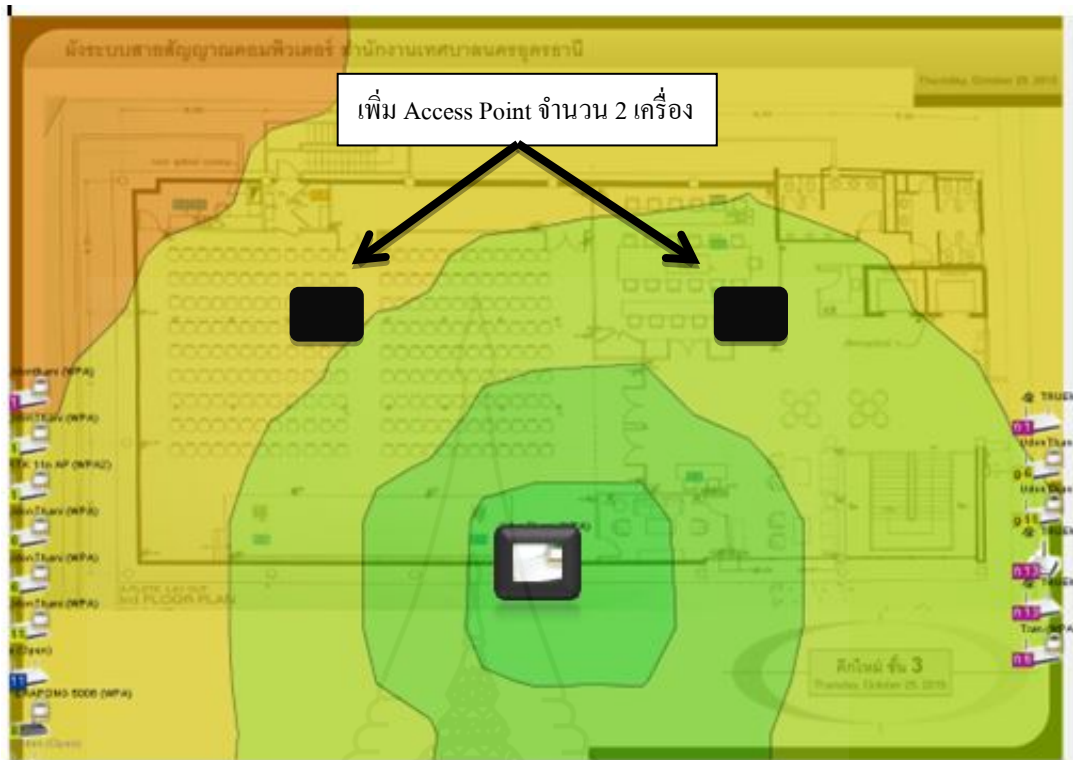
ภาพที่ 5.5 การกำหนดจุดติดตั้งเพิ่มเติม ชั้น 3 อาคารอจรรย์ระ
