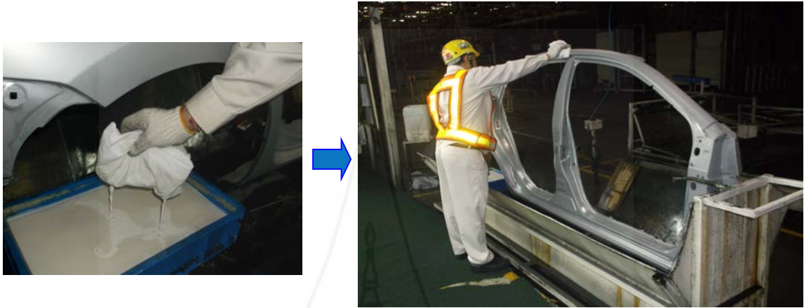
ภาพที่ 2.6 การจุ่มและการทาน้ำมันป้องกันพื้นผิวรถยนต์
