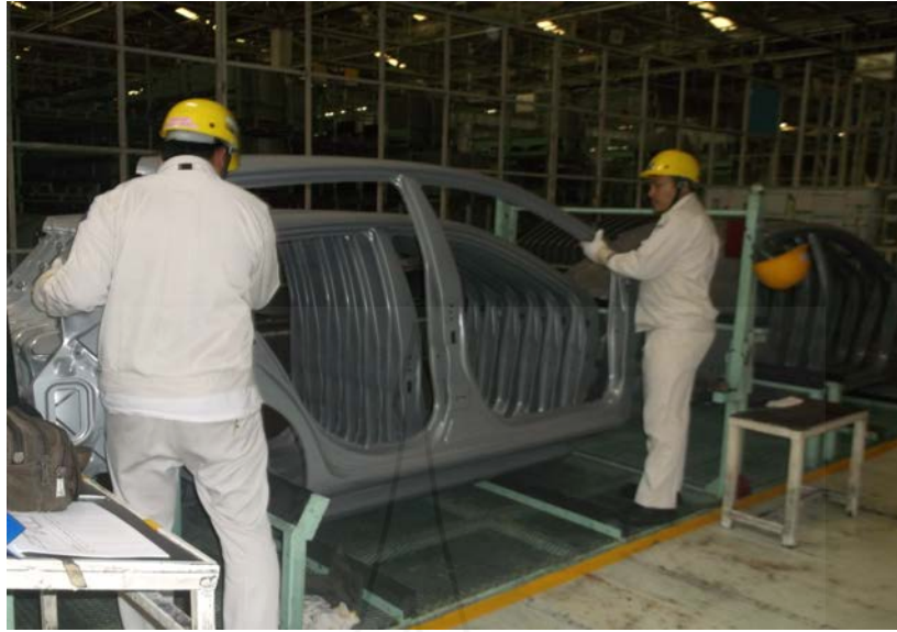
ภาพที่ 2.4 การยกชิ้นส่วนรถยนต์ออกจากภาชนะรองรับ
