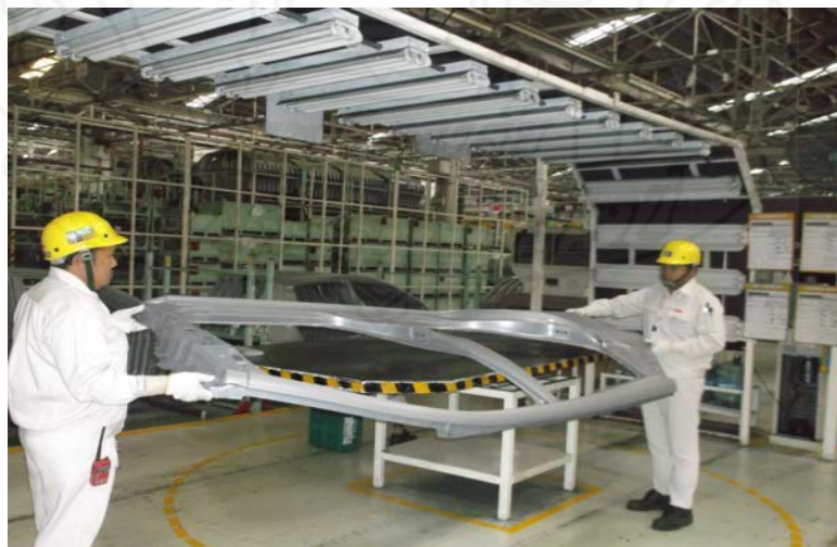
ภาพที่ 2.5 การตรวจสอบรอยบุบรอยนูนบนพื้นผิวชิ้นส่วนรถยนต์
